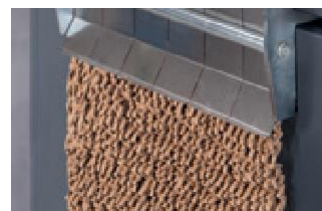
Výroba zlisovaného obalového materiálu s uzatvorenou kompresnou klapkou (ProfiPack P425).
